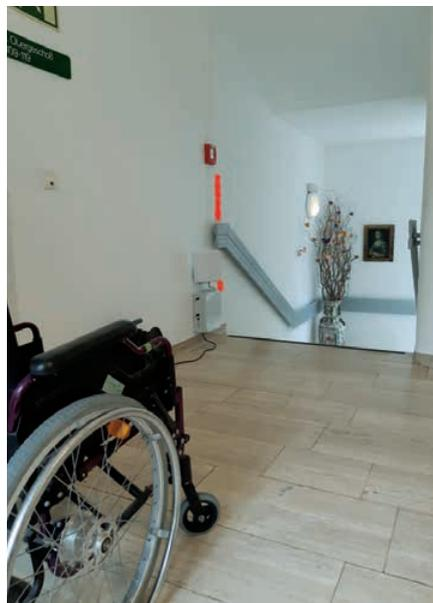
Prototyp der Rollstuhl-Treppenwarnanlage
