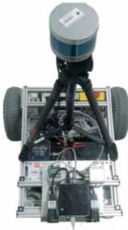
Volksbot-Roboter: Aufbau des 3D-Mappingsystem „MSM“ mit Laserscanner Velodyne VLP-16 als SLAM-Sensor. Im Vordergrund die GNSS/MEMS/Kamera-MSM-Navigationsbox für SLAM. Foto: Reiner Jäger
