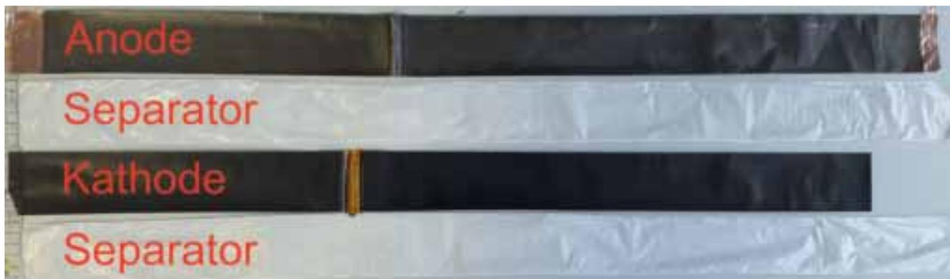
Abb. 2: De-assemblierter Wickel (jelly roll) einer 18650-Zelle mit dem durch einen Separator getrennten Anoden- und Kathodenband
