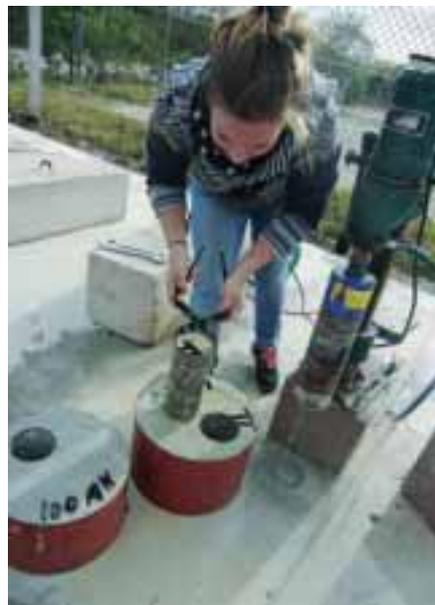
Doktorandin Sandra Lichtblau entnimmt Bohrkerne zu Prüfzwecken. Foto: Sandra Lichtblau
