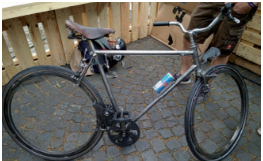
Der „Imperator“: speichenlos dank Zahnkranzantrieb und eigens entwickeltem Getriebe
