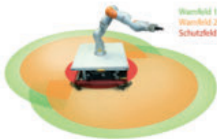
Abb.1: Einteilung der Roboterumgebung in unterschiedliche Felder, zwei Laserscanner ermöglichen eine Rundumsicht Bild: N. Gatz
