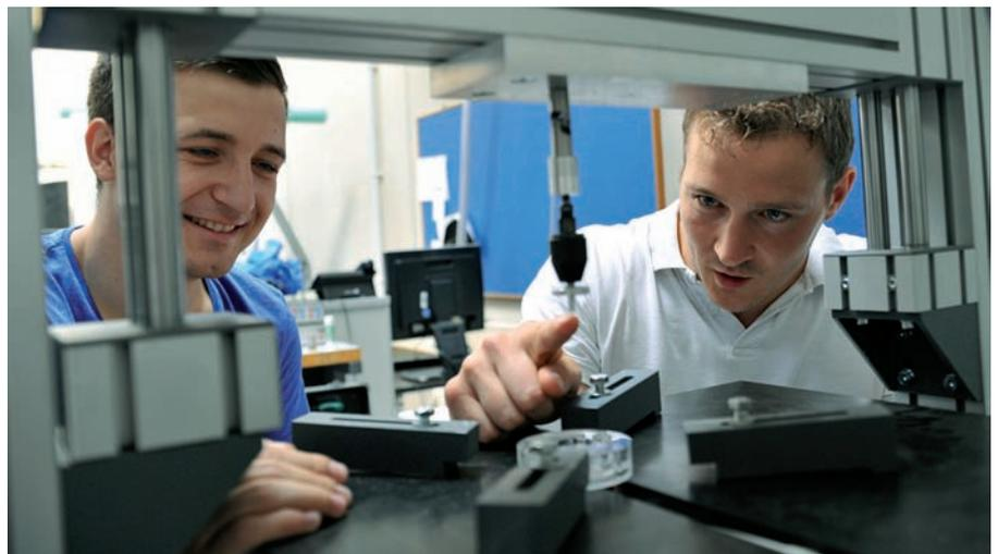
Maschinenbaustudent Simeon Wacker (l.) und Promotionsstipendiat Jakob Schaaf untersuchen die Adhäsionskraft zwischen Eis und einer Aluminiumprobe, um ein neues Verfahren zur Herstellung von Eisbreni zu erforschen. Foto: John Christ/HsKA
