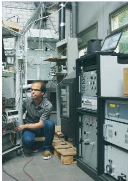
HT-FTIR-Gasanalysesystem (im Vordergrund rechts) mit einem am ISIS-Feuerungstechnikum mit Sensorik und Aktorik ausgestatteten Kaminofen (Spartherm GmbH, Hintergrund), Experimentator: Mario Schütt
