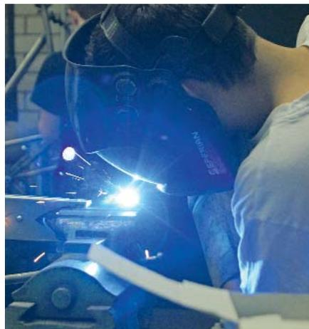
Der Heckrahmen wird aus etlichen Einzelrohren zusammenschweißt, die zuvor mit einem Laser maßgerecht zurechtgeschnitten wurden.
