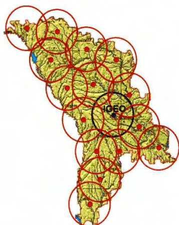
Abb. 1: Moldawien mit den 15 Referenzstationen des GNSS-Positionierungsdienstes MOLDPOS und Rechenzentrum IGEO in der Hauptstadt Chisinau
