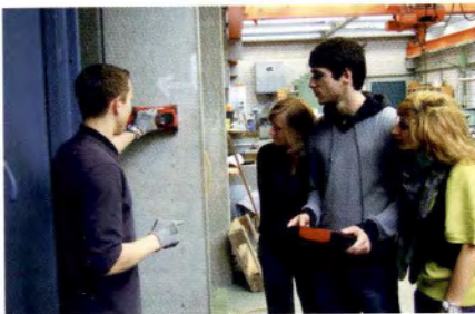
Demonstration eines auf magnetischer Basis arbeitenden Ortungssystems für Betonstahlbewehrung in den Räumen der ÖBP Foto: ÖBP
