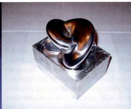
Fertigungstechnik: Knoten – als 3-D-CAD-Modell und durch 5-Achs-Simultanfräsen am IMP gefertigt Foto: IMP
