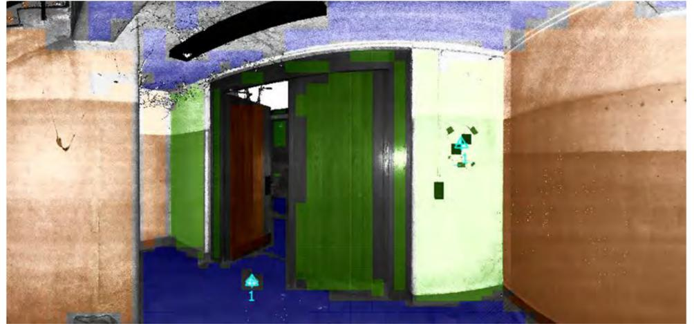
Detektierte Ebenen, Referenzkugel und Schachbrettmuster in dem Registrierungsprogramm Scantra
